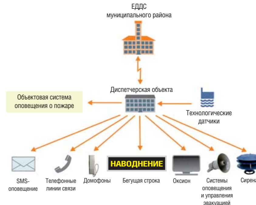
Рис. 1. Организация локальной системы оповещения
